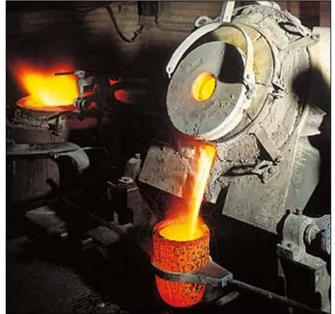
*Blick in die Produktion: Gasbeheizte Tiegelöfen (oben),
