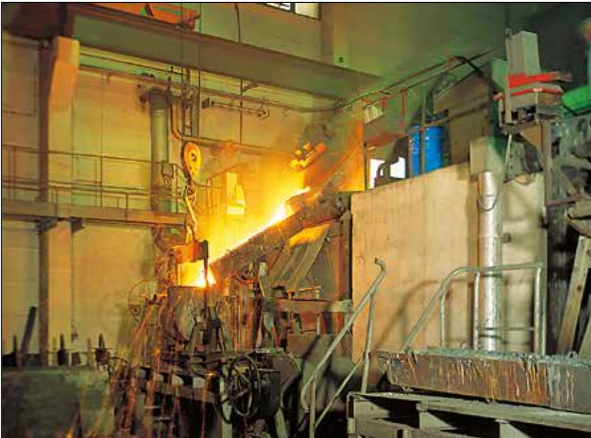
*Als Produktionsstandort in den Neuen Bundesländern wird eine Grauguss-Gießerei in Gera von der Treuhand übernommen (Bild oben: Bürogebäude mit Produktionshallen). Im unteren Bild ein Mittelfrequenz-Induktionsschmelzofen. Einzelstücke bis zu zwei Tonnen Gewicht können dort gegossen werden. Außerdem wurde eine NE-Metallgießerei angegliedert.*
