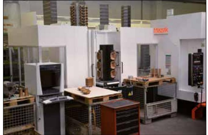
*Palettenturm der Mazak Nexus 5000-II wird bestückt*
