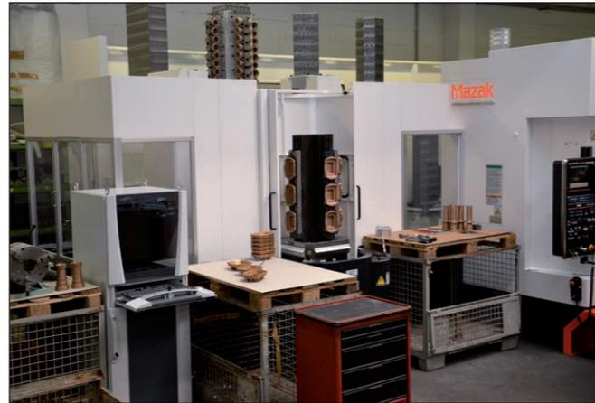
*Palettenturm der Mazak Nexus 5000-II wird bestückt*
