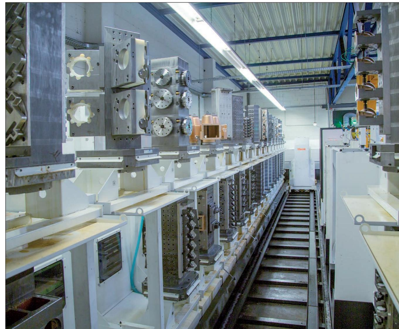
*Innenansicht der Mazak Nexus 5000-II nach der Erweiterung auf 36 Palettenplätze für eine vollautomatische Produktbearbeitung*
